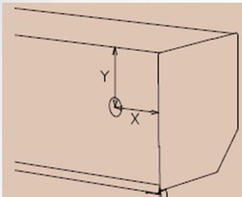
Mesurer l'emplacement de l'axe de la sortie du câble sur le coffre (Cotes X, Y).
