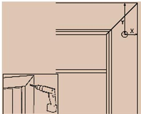
Reporter l'emplacement de l'axe de la sortie du câble sur la menuiserie (s'assurer qu'elle ne gêne pas l'ouverture de la fenêtre), puis percer le trou pour le passage du câble moteur  $\square$  10 mm.
