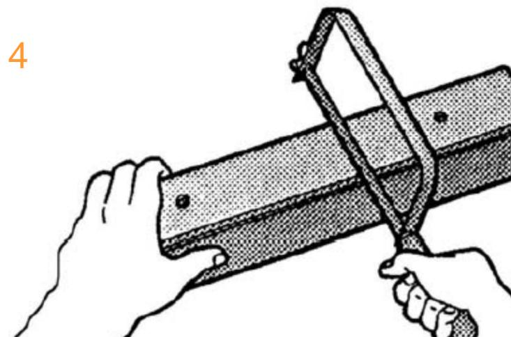
Coupez le profil de compensation aluminium à la largeur tableau prise moins 8 mm !!. Ce profil est toujours livré plus long pour des questions de finition.
