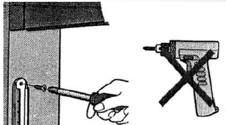
Serrez les plaques de fixation avec les vises. Surtout faites-le à la main. Ne pas utiliser de visseuse électrique..
