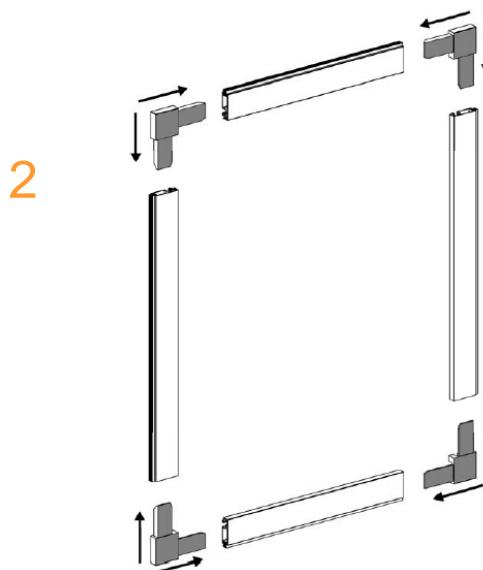
2 -Montage du cadre de moustiquaire: Insérez les équerres dans les profils d'encadrement en vérifiant que les cotés sans rainures du profils concordent avec la partie lisse des équerres.
