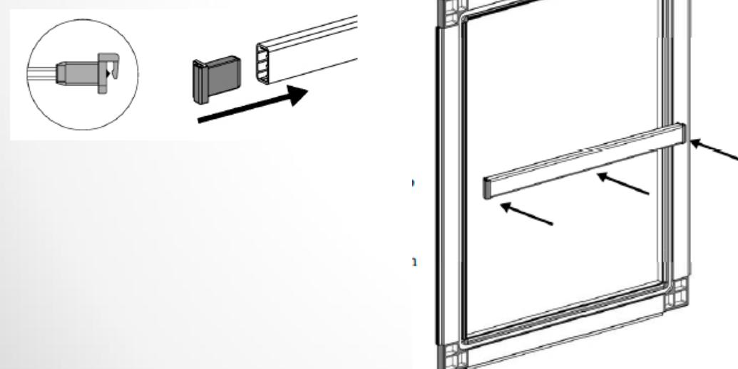
3 -Si la dimension de la moustiquaire est supérieure à 1500 mm de largeur ou de haut, une traverse est prévue automatiquement. Introduisez les embouts des traverses au profil de façon à ce que l'embout sorte de 0,5 mm et mettez les bouchons aux extrémités du profil. Une fois installés « cliquez » la traverse au centre de la moustiquaire.
