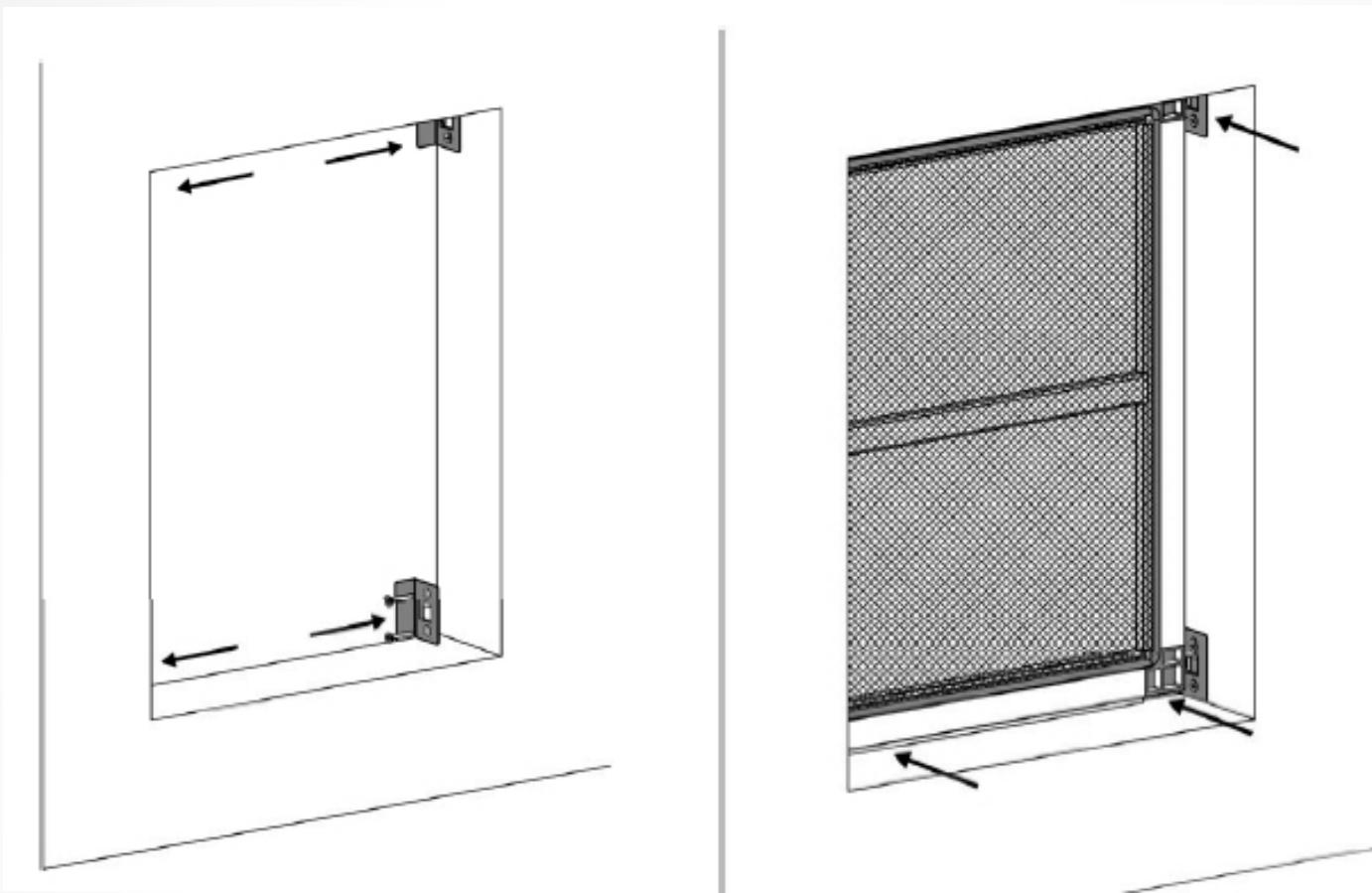
Fixez les supports dans les 4 coins de votre tableau puis introduisez la moustiquaire en faisant une pression de façon à ce qu'elle s'insère au niveau des supports
