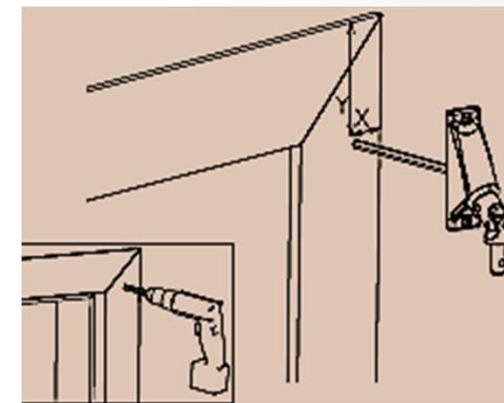
Reporter l'emplacement de l'axe de la sortie de manoeuvre sur la menuiserie (s'assurer qu'elle ne gêne pas l'ouverture de la fenêtre), puis percer le trou de manoeuvre
