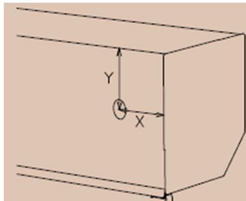
Mesurer l'emplacement de l'axe de la sortie de la manoeuvre treuil sur le coffre (Cotes X, Y).
