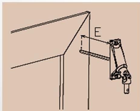
Enfoncer le cardan à fond dans son logement (s'assurer qu'il entraîne le mécanisme). Mesurer l'excédant « E ».
