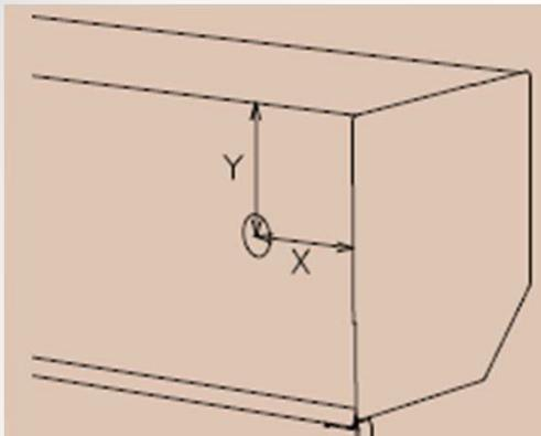
Mesurer l'emplacement de l'axe de la sortie du cable sur le coffre (Cotes X, Y).
