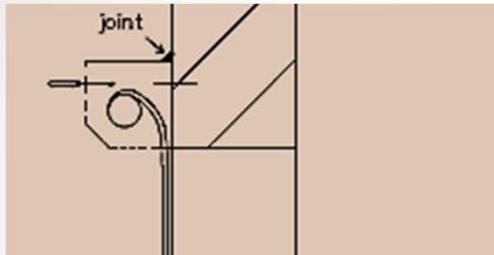
*Pose en applique (C) : Fixer le caisson au mur après avoir descendu le tablier et enlevé le capot. Puis faire un joint au mastic sur le haut du coffre.*
