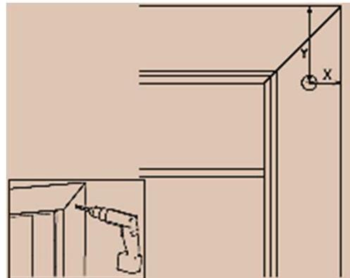
Reporter l'emplacement de l'axe de la sortie du cable sur la menuiserie (s'assurer qu'elle ne gène pas l'ouverture de la fenêtre), puis percer le trou pour le passage du cable moteur □ 10 mm.
